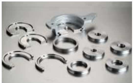
Пуансоны и матрицы разных размеров
