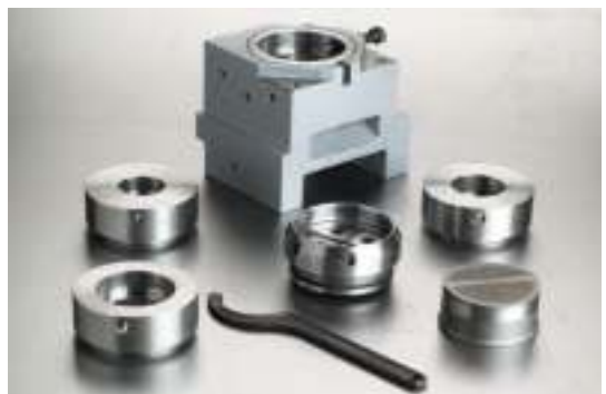
Пуансоны и матрицы разных размеров
